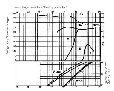
Kühlzeit von 800°C auf 500°C in Sek. / Cooling time in sec. from 800°C to 500°C (1472 - 932°F)
