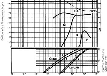
Kühlzeit von 800°C auf 500°C in Sek. / Cooling time in sec. from 800°C to 500°C (1472 - 932°F)
